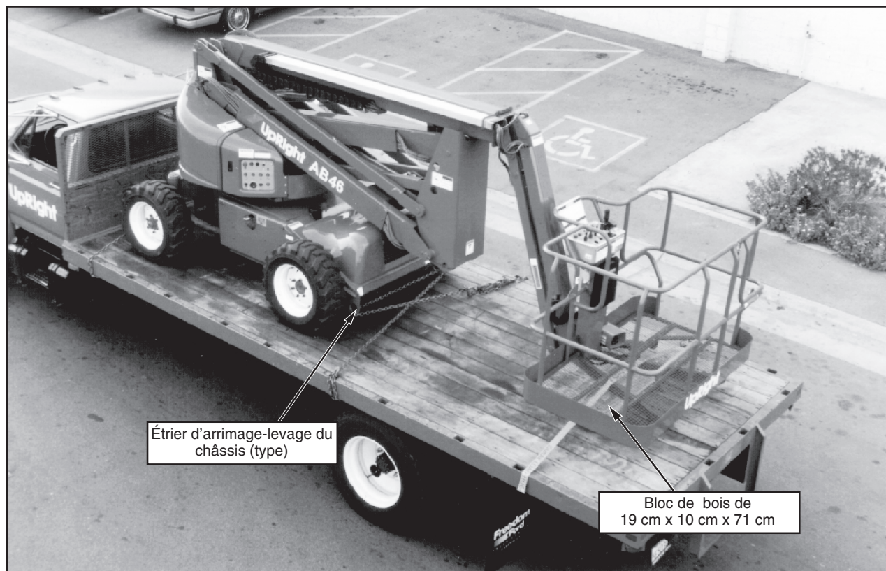
Figure 6 : Arrimage de la machine pour fin de transport
