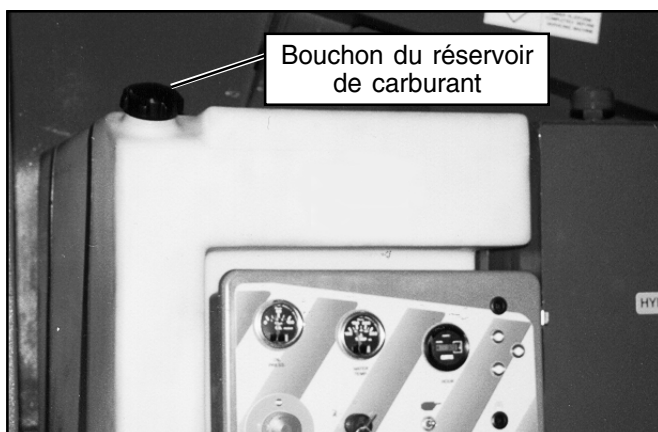
Figure 13 : Réservoir de carburant
