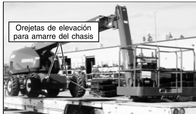
Figura 10: Orejetas de elevación para amarre del chasis trasero
