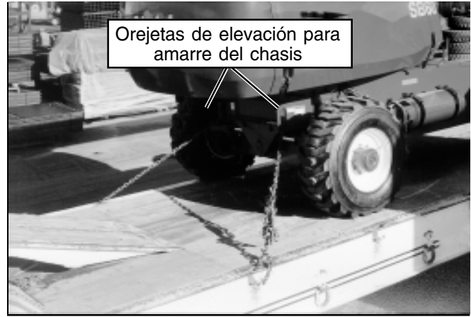
Figura 8: Orejetas de elevación para amarre del chasis delantero
