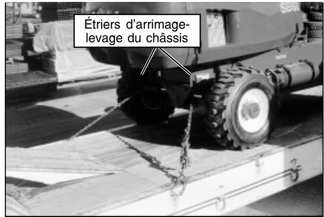
Figure 8 : Étriers d'arrimage-levage du châssis avant
