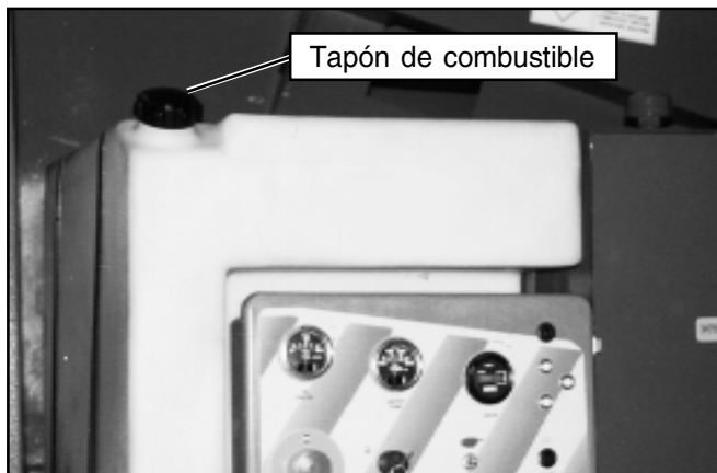
Figura 13: Depósito de combustible
