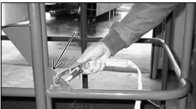
Abbildung 6: Typischer Verankerungspunkt für Haltegurte
