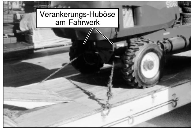
Abbildung 8: Vordere Verankerungs-Hubösen am Fahrwerk
