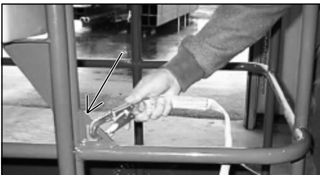
Figure 6 : Point de fixation type pour dispositif antichute
